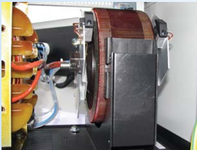
Тороидальный регулятор напряжения с двухсторонними токосъемниками
